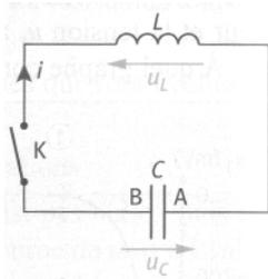
1. Exprimer les tensions  $u_C(t)$  et  $u_L(t)$  en fonction de  $q(t)$ ,  $L$  et  $C$ . Établir l'équation différentielle vérifiée par  $q(t)$ .
