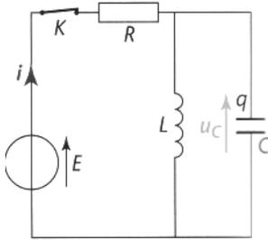
1. On réalise le montage schématisé ci-contre avec  $R = 25 \Omega$ ,  $C = 0,45 \mu\text{F}$ ,  $E = 12,0\text{V}$ . La valeur de l'inductance  $L$  est inconnue. L'interrupteur  $K$  est fermé depuis un temps suffisamment long pour que le régime permanent soit établi.
